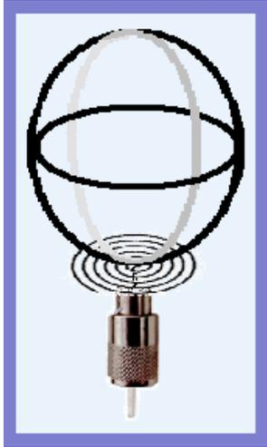
Idea gráfica. Sobre la mesa colocamos una pelota de tenis, que representa a la parte esférica de la antena. El polo sur apoya sobre la mesa. Entonces levantamos la pelota un poquito y construimos la bobina entre la mesa y el polo sur de la esfera. Esa es la idea para ubicar adecuadamente la bobina.
