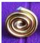
En la imagen se ve una bobina espiral plana de pocas vueltas, hecha con alambre esmaltado. El alambre usado en la antena es envainado. Esa es la diferencia. Lo similar es la forma geométrica. La imagen fue incluida solamente para dar idea de la forma.
