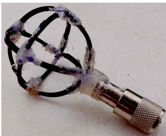
El alambre irradiante es continuo, sin cortes. Simplemente ha sido moldeado para formar 4 meridianos y el ecuador, en semejanza con la geometría de un planeta. Un par de meridianos está dispuesto en un plano y el otro par en un plano perpendicular al anterior. La antena se monta directamente en un conector tipo PL259, porque su diámetro de 52 mm lo permite.
