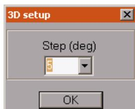
Aparece con valor 5 , que da la mejor resolución. Aplicamos el mouse en OK y acepta el valor 5 . En caso de simular un sistema irradiante que tenga geometría compleja, el valor 5 puede demorar la resolución. En ese caso antes de aplicar el mouse en OK cambiaremos a 10.
