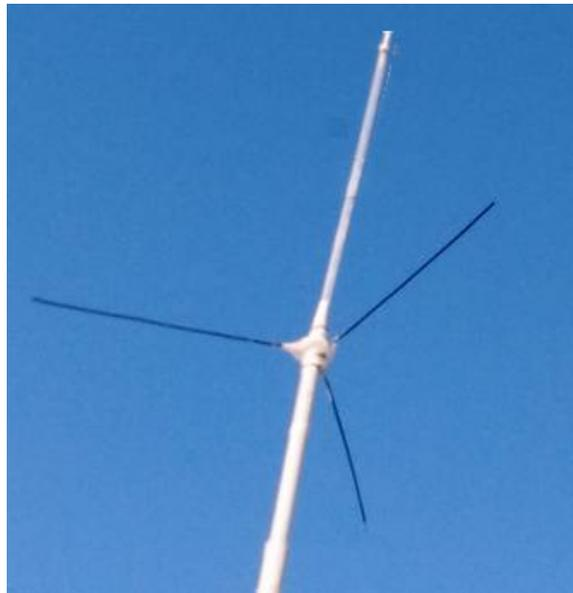
Geoméricamente no hay novedad. Es un irradiante vertical con tres radiales perpendiculares al irradiante. El irradiante mide 613 mm y cada radial 327 mm . En eso está la novedad. Nuestro primer impulso es hacer cuentas con la intención de explicar esas medidas como fracciones racionales de la longitud de onda. La explicación en realidad se basa en la solución
