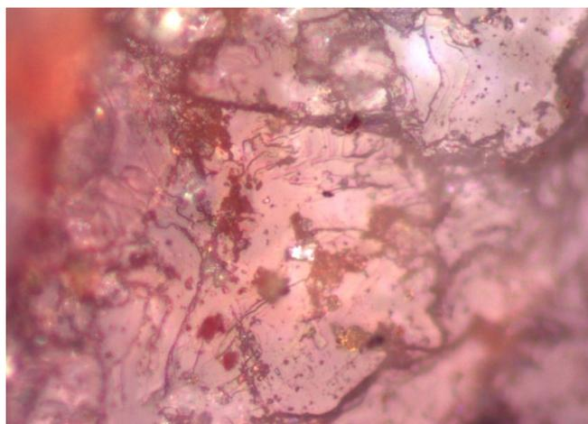
Sample Site 24 : Stone 3\_spectra 1 indicates : **Augite** ( Image: ~ 500 x 400 μm )
