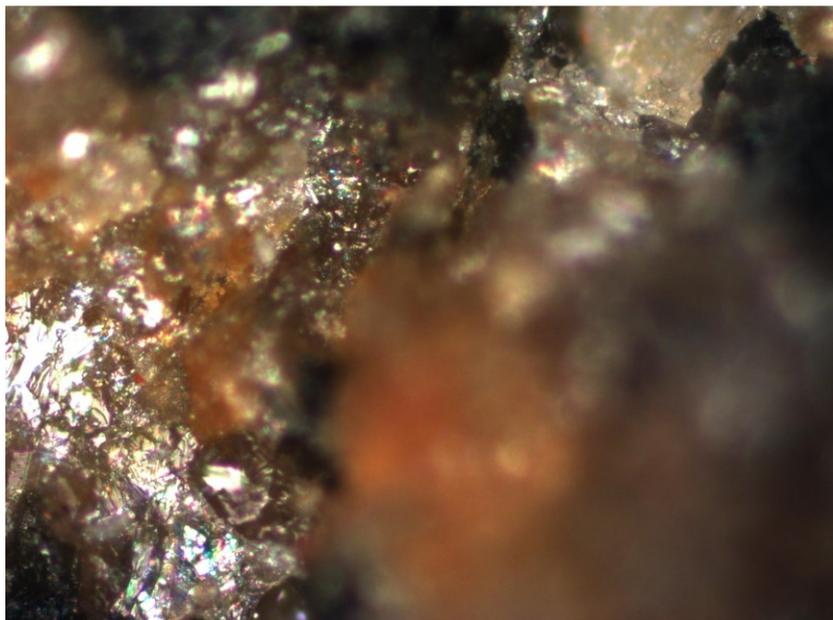
Sample Site 23 : Stone 3\_spectra 1 indicates : **Microcline** ( Image ~ 500 x 400 μm )
