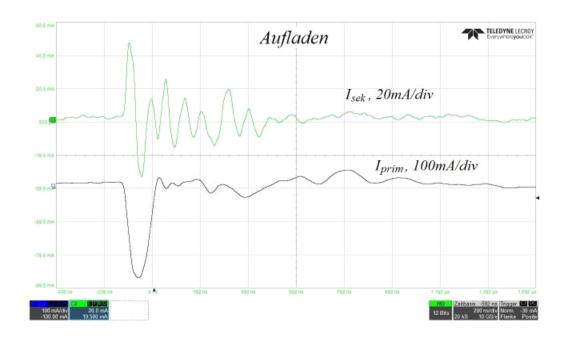
Danach wurde zweifacher Schalter *S1* abgeschaltet und einfacher Schalter *S2* sofort geschlossen. Das Ergebnis der Umschaltungen ist in nächstem Oszillogramm gezeigt:
