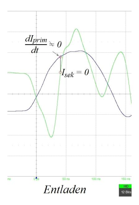
Der Primärstrom erzeugt rotierendes Magnetfeld (Amperesches Gesetz):
