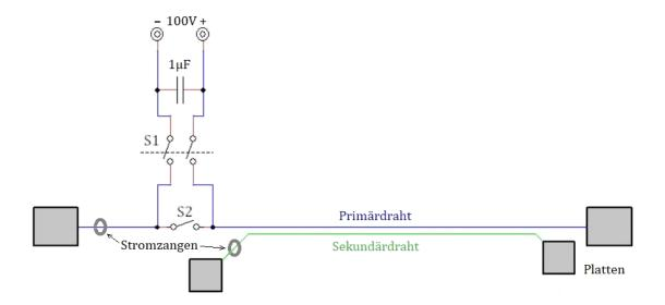
Die Stromzangen werden gleichsinnig – Stromrichtung nach links – an die Drähte angebracht. Nächstes Foto zeigt verwendete Ausrüstung.
