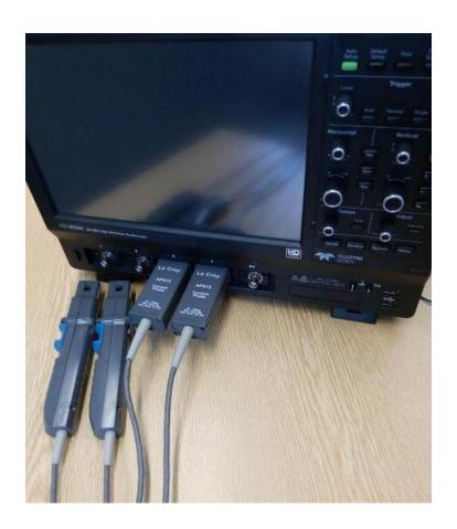
Die Schalthandlungen waren folgende: Das DC-Netzteil wurde an 1µF Kondensator über Bananen-Stecker angeschlossen und die Ausgangsspannung auf 100V eingestellt. Während einfacher Schalter S2 weiterhin offen blieb, wurde zweifacher Schalter S1 zugeschaltet. Das Oszilloskop triggerte auf Primärstrompuls und zeichnete folgende Kurvenverläufe.
