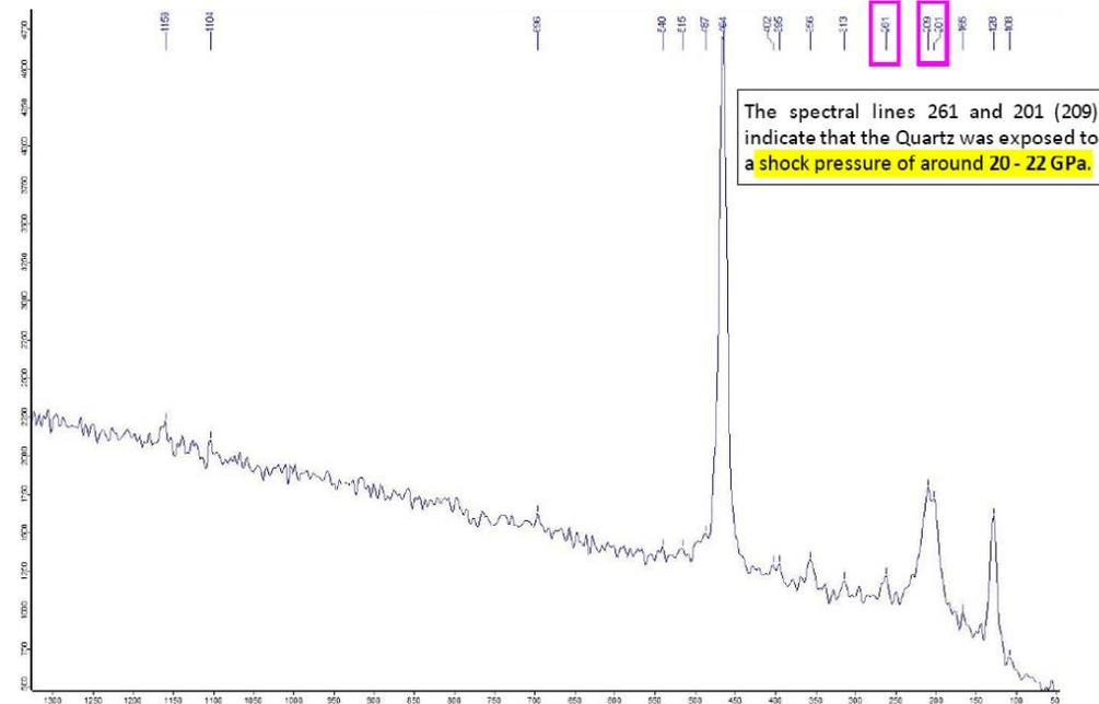
Sample Site **21** : Stone 2 : **Quartz** - Image size : ~ 400 x 300 μm
