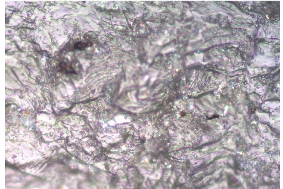
Sample Site **21** : Stone 1 : **Quartz** - Image size : 250 x 200 μm
