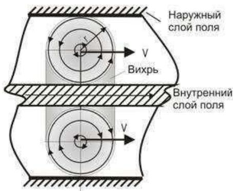
Рисунок 1.24. Движение тороидального вихря в «вязкой трубе»
