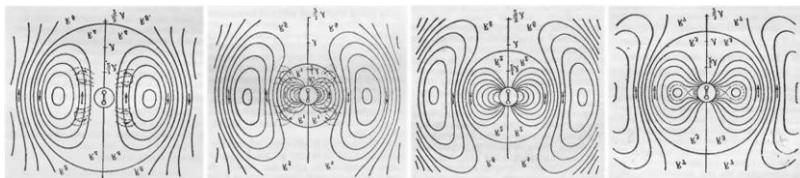
*Рисунок 6.15. Образование вихрей поля в вибраторе Герца
