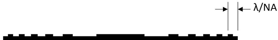
$\lambda=13.5\text{nm}$ :  $\sim 89\text{ nm}$  Mo (pattern) /  $50\text{ nm}$  Si (substrate)
