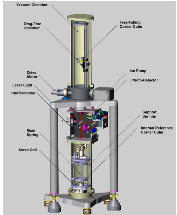
FIG. 1. FG5 gravimeter
