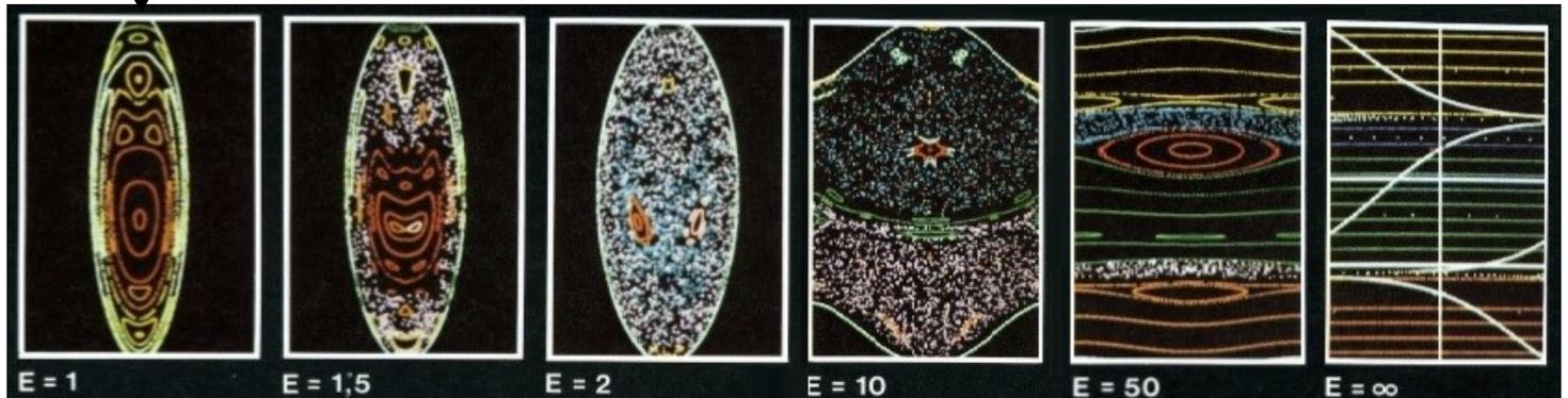
Abb. 5. Poincaré-Schnitte für das ebene Doppelpendel bei verschiedenen Werten der Gesamtenergie  $E$  (in Einheiten von  $mgL$ ). Auf der Abszisse ist der Winkel  $\varphi_1$ , des inneren Pendels, auf der Ordinate der entsprechende Drehimpuls  $L_1$ , aufgetragen. Die Bewegung wird immer dann aufgezeigt,
