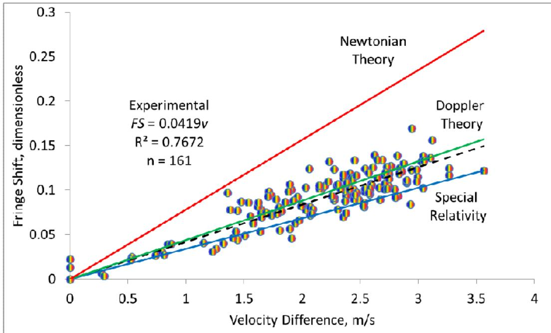
Красная линия соответствует классической формуле сложения, которая следует из принципа относительности Галилея:  $v' = V + U = V + \frac{c}{n}$ , где  $n$  — показатель преломления воды. В этом случае интерференционный сдвиг выражается формулой [8]:
