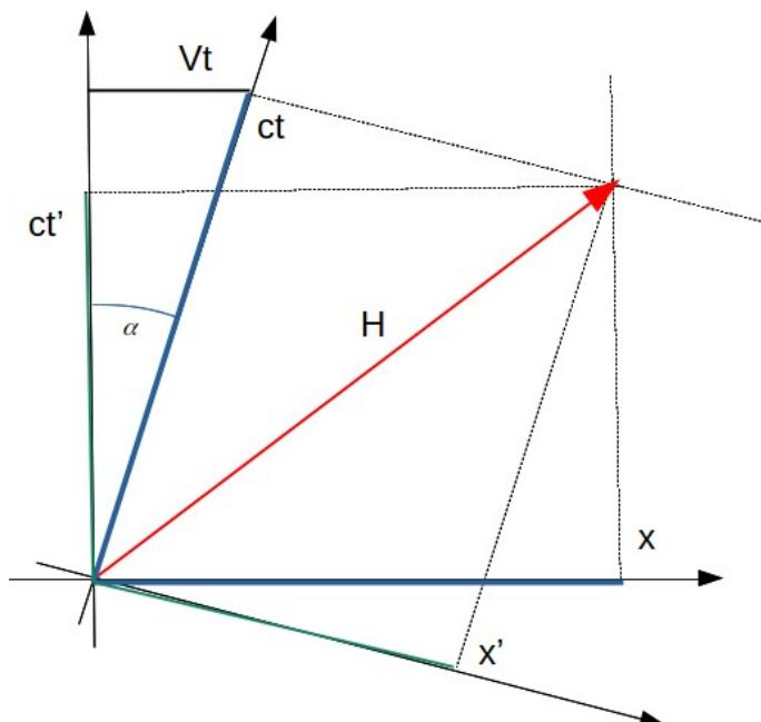
Из ортогональности такого преобразования следует, что длина этого вектора в одной системе координат равна длине в другой системе
