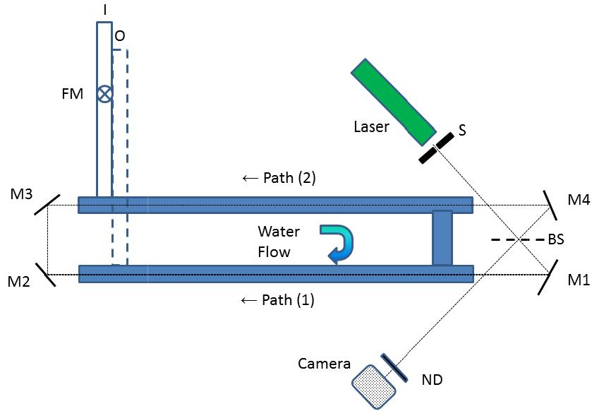
Вода прогоняется по двум трубам. FM — это измеритель скорости потока. Свет лазера с помощью зеркал M1, M2, M3 и M4 направляется вдоль труб через BS — полупрозрачное стекло, которое расщепляет свет на два пучка. Камерой фиксируется интерференция этих двух пучков.
