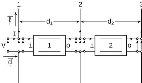
Fig. 1: End-fed linear array of 3 linear dipoles
