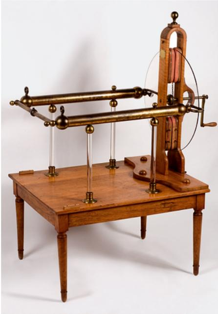
Ilustración 7: Máquina Electrostática
