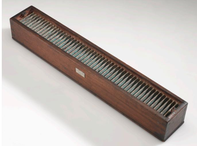
Ilustración 11: Batería de Cruickshank
