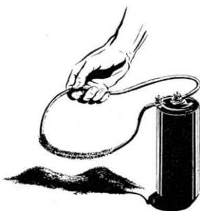
Ilustración 22: Atracción limaduras de hierro
