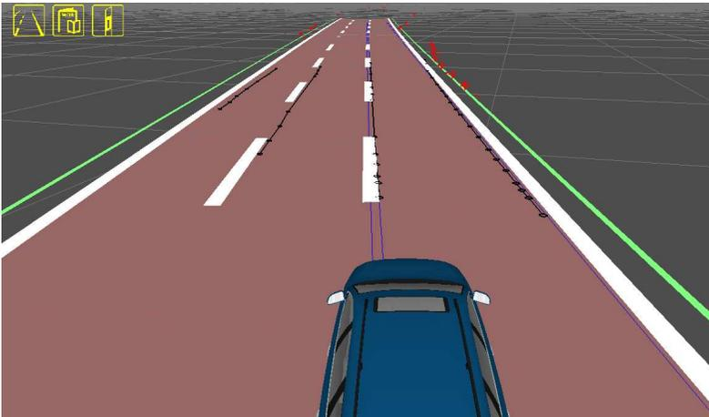
Abbildung 3.7.: Aus Radarreflexen von Leitplanken (rote Punkte) kann eine Schätzung der Randbebauung (grüne Linien) erfolgen. Diese gehen zusammen mit Fahrbahnmarkierungen (schwarze Linienzüge) und Kartendaten (blaue Linien) in die Fahrbahnschätzung (rote Straße) ein.
