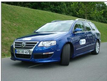
(a) Versuchsträger für das HAVEit-Projekt ausgerüstet mit Laserscanner, Radarsensor, Ultraschallsensoren, GPS und digitaler Karte
