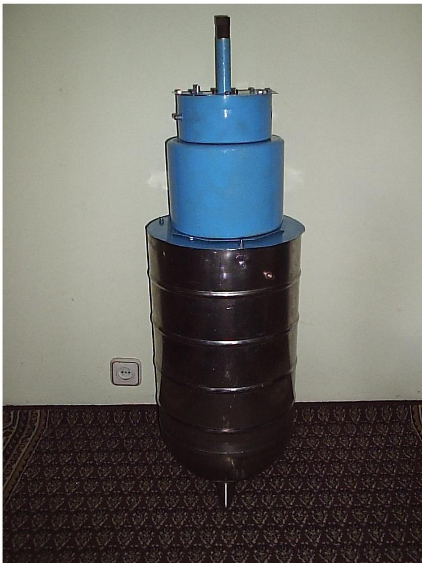
Рис. 6. Фотография экспериментальной установка в разобранном виде.
