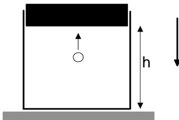
Fig. 12 - O êmbolo desloca-se na vertical acelerado pelo campo gravitacional  $g$ , e sujeito às colisões do "gás" representado pela partícula que se move na vertical.
