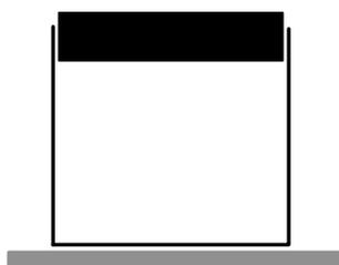
Fig.2 O êmbolo não cai no solo porque as moléculas de ar são confinadas pelas paredes do cilindro.
