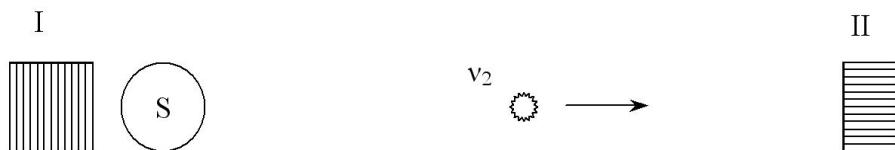
Рис.1 Схема эксперимента для исследования квантовой корреляции запутанных частиц. После коллапса первого фотона  $V_1$  (на рисунке не показан) на поляризаторе I второй фотон  $V_2$  приобретает одну из двух возможных поляризаций: параллельную или перпендикулярную к направлению поляризатора I.
