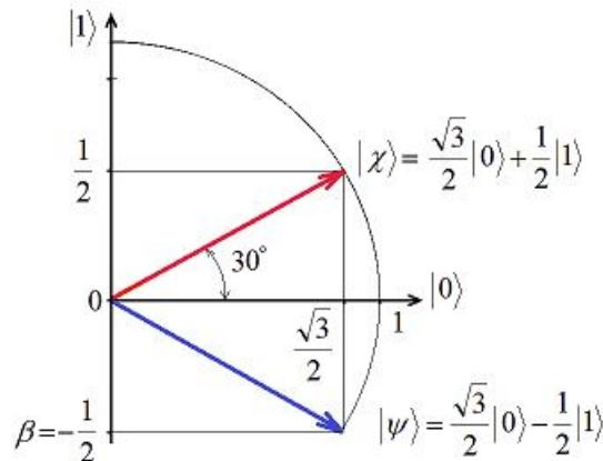
Этот фотон пройдёт через поляризатор с такой же вероятностью, что и вертикально поляризованный фотон:
